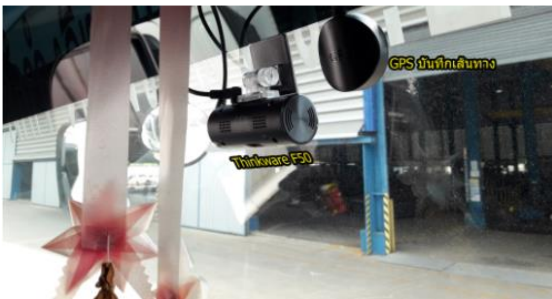
ภาพที่ 3.13 การติดตั้งกล้อง Car Camera และ GPS ในการติดตั้งหน้ารถ
