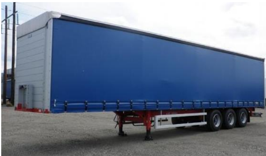
ภาพที่ 3.25 โครงสร้างรับสินค้าแบบถอดตู้ออกได้
