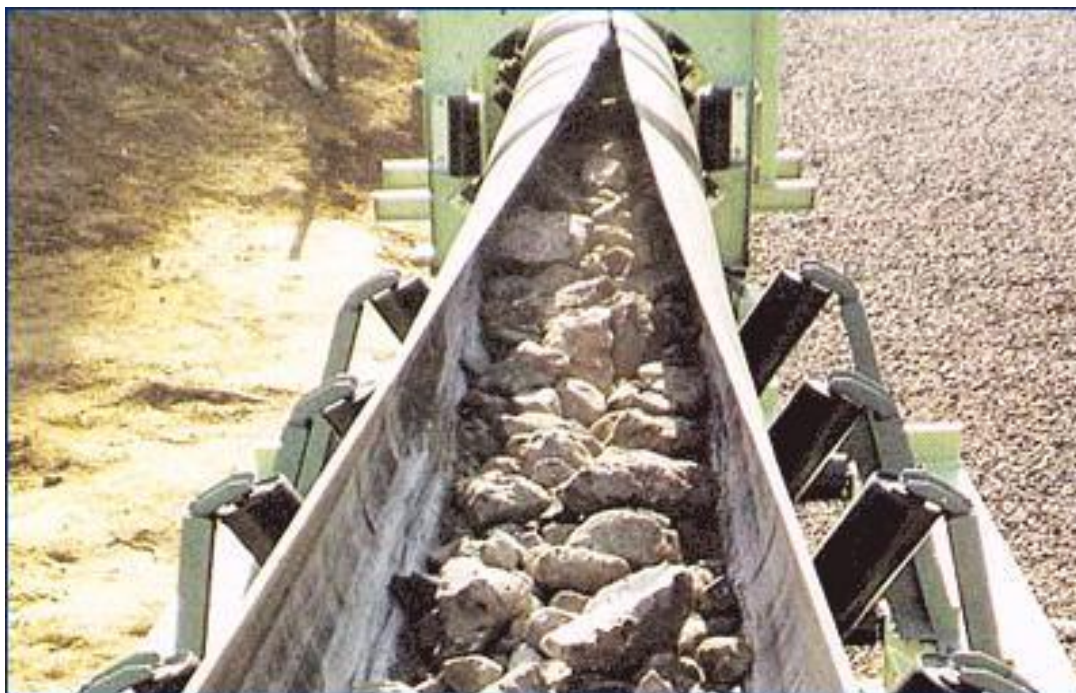
ภาพที่ 3.16 สายพานลำเลียงแบบโครงสร้างพิเศษ
