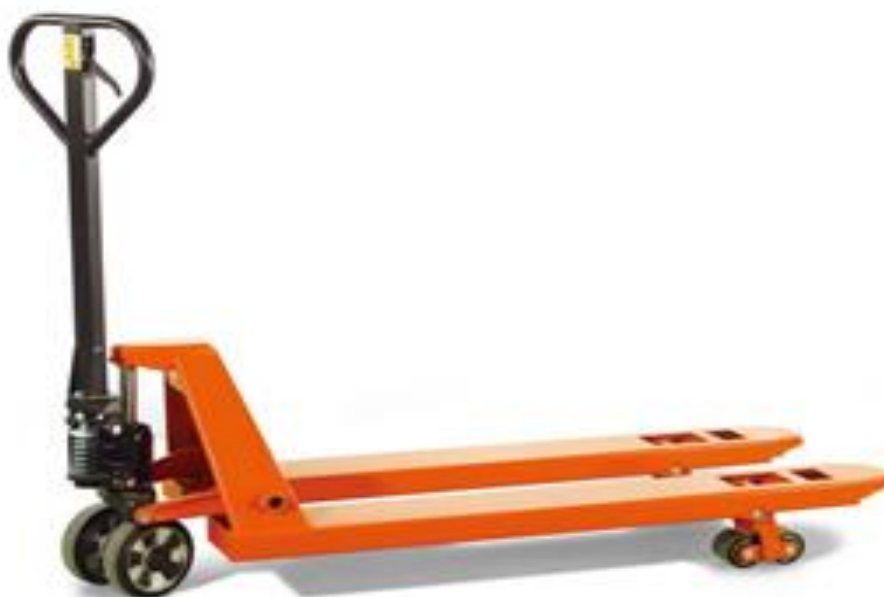
ภาพที่ 3.8 รถลากที่ใช้กับพาเลท
