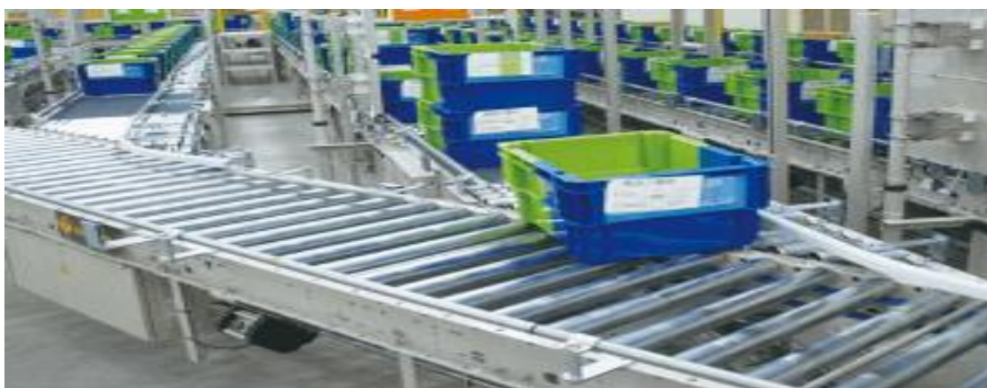
รูปภาพที่ 3.11 ภาพแสดงตัวอย่างของรางเลื่อนและสายพานลำเลียง
