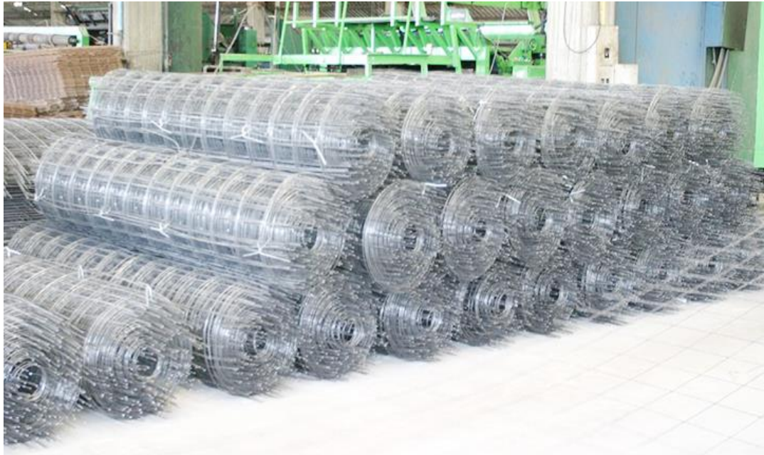
ภาพที่ 2.5 ตะแกรงเหล็กเสริมคอนกรีต
