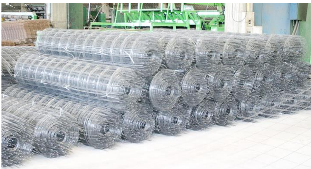
ภาพที่ 2.5 ตะแกรงเหล็กเสริมคอนกรีต
