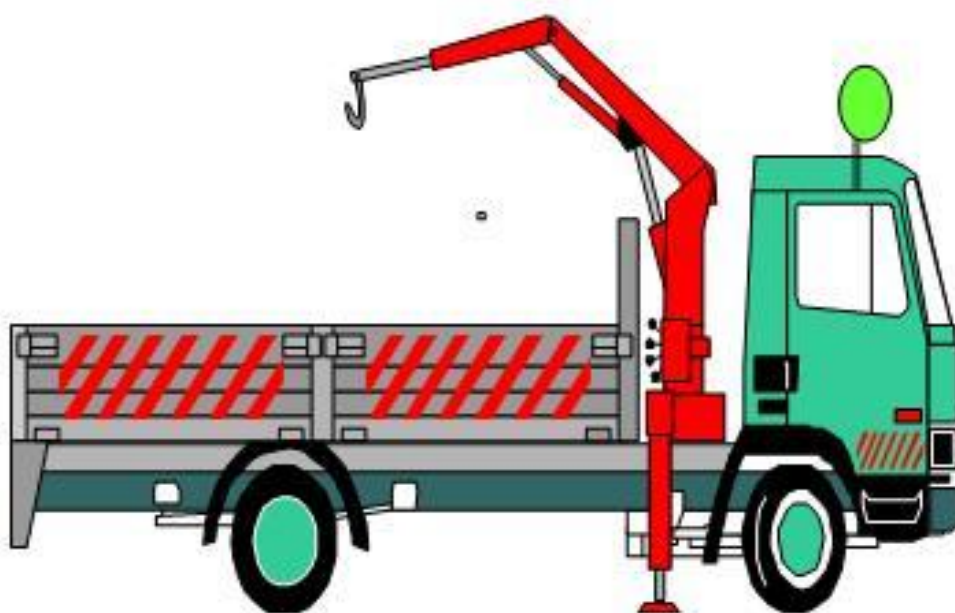
ภาพที่ 3.8 กระบะบรรทุกติดตั้งเครื่องทุ่นแรง
