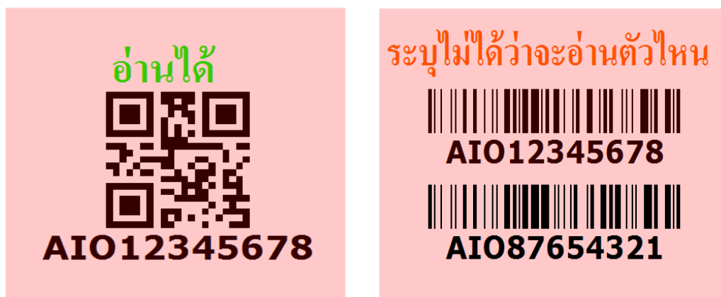
ภาพที่3.15 ภาพแสดงบาร์โค้ด 2 มิติที่อ่านได้และอ่านไม่ได้
