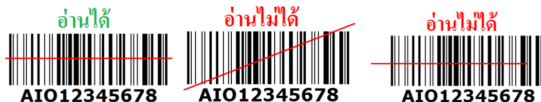
ภาพที่ 3.13 ตัวอย่างการใช้เครื่องอ่านบาร์โค้ดหัวอ่าน 1 มิติ
