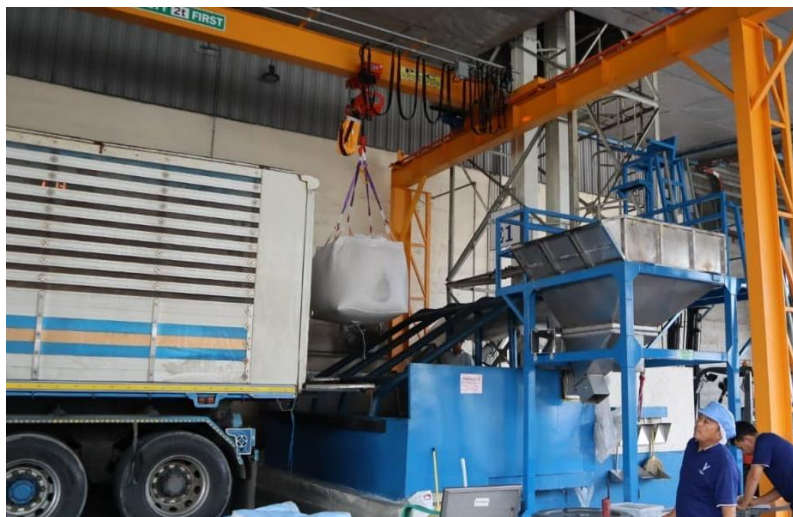
ภาพที่ 4.4 การเทข้าวลงหลุมข้าว โดยใช้เครน
