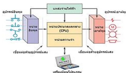
ภาพที่ 3.6 โครงสร้างของโปรแกรมเมเบิลคอนโทรลเลอร์
