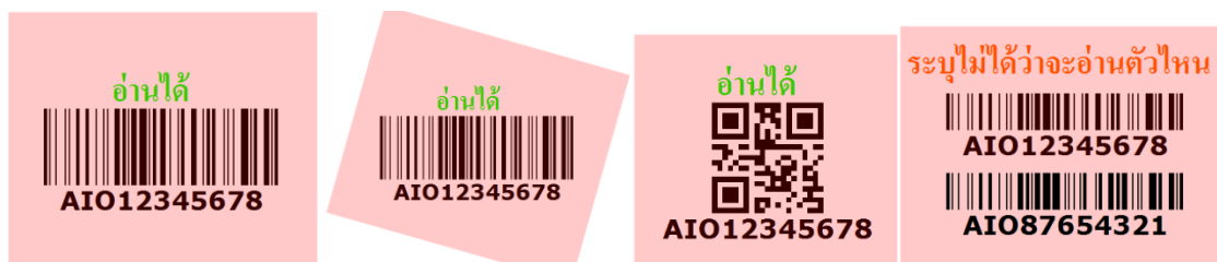
ภาพที่ 3.14 ตัวอย่างการใช้เครื่องอ่านบาร์โค้ดหัวอ่าน 2 มิติ
