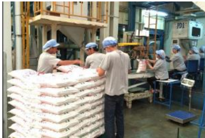
ภาพที่ 4.10 ส่วนของLine packing ซึ่งจะเริ่มจากกรอกข้าวลงถุงเย็บถุง และลำเลียงถุงวางบน pallet
