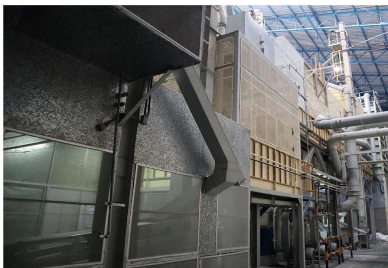
ภาพที่ 4.5 เครื่องแยกฝุ่นราและเครื่องแยกหินเพื่อทำความสะอาดข้าว
