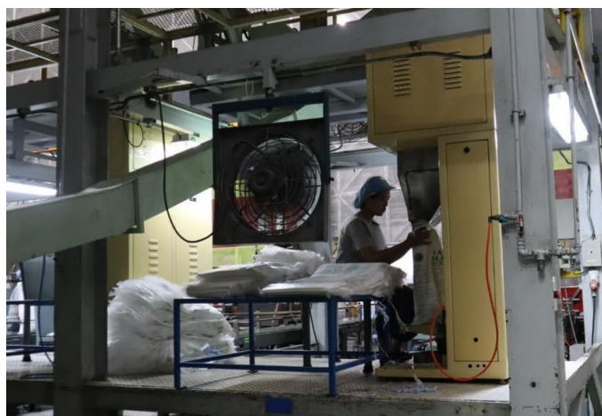
ภาพที่ 4.8 การจับปากถุงกรอกข้าวใส่ในถุงบรรจุภัณฑ์ด้วยเครื่องอัตโนมัติ
