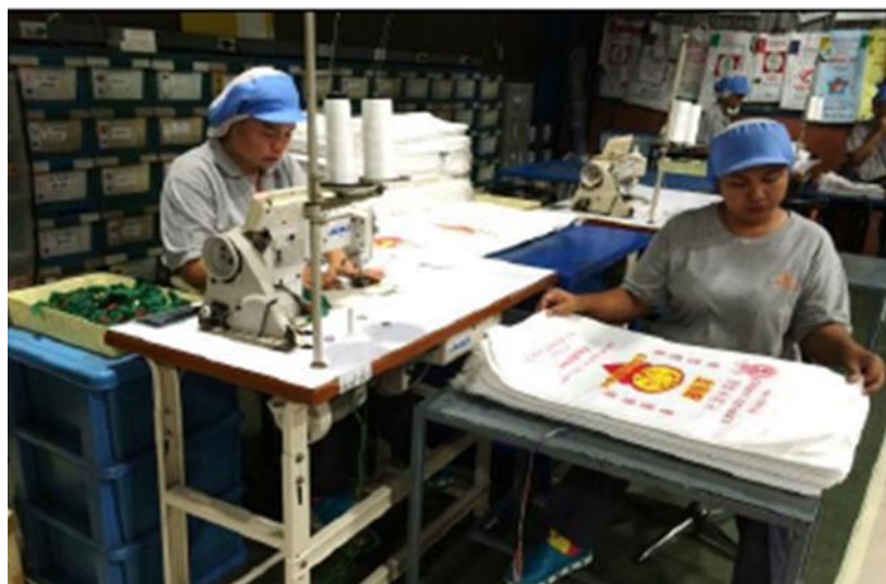
ภาพที่ 4.2 การเย็บเหรียญและติดบาร์โค้ดที่บรรจุภัณฑ์
