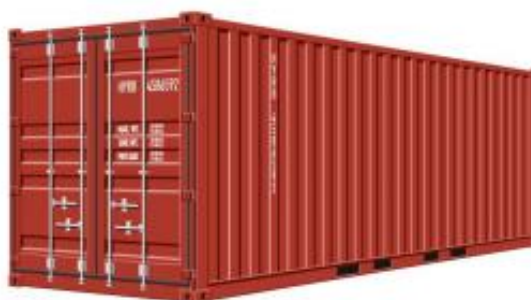
ภาพที่ 3.8 Dry container
