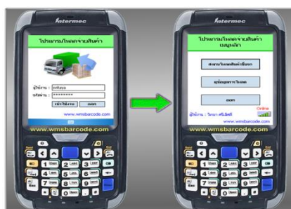
ภาพที่ 3.20 รูปแสดงหน้าจอการโหดจ่ายสินค้า ด้วยระบบบาร์โค้ดบน Handheld
