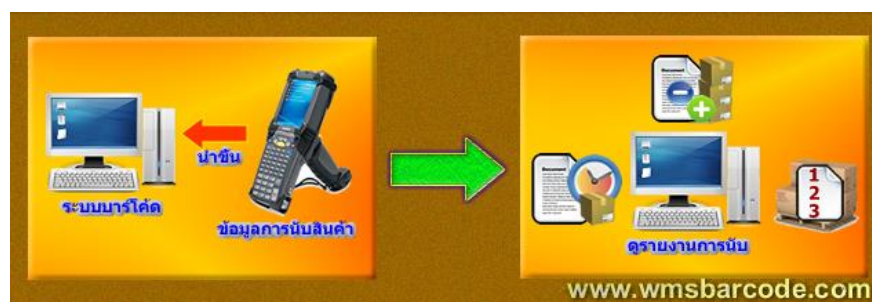
ภาพที่ 3.15 นำข้อมูลการสแกนนับสินค้าบน Handheld ขึ้นสู่ PC เพื่อดูรายงานการนับสินค้า
