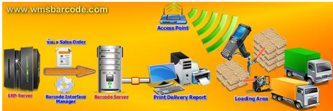
ภาพที่ 3.17 การออกแบบระบบบาร์โค้ดสำหรับโหลดสินค้าที่มีการทำงานแบบ Real Time และเชื่อมต่อกับ ERP
