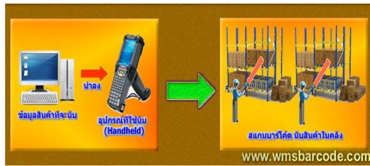
ภาพที่ 3.12 นำข้อมูลแผนการนับลง Handheld ให้พนักงานคลังใช้ในการสแกนนับสินค้าในคลัง
