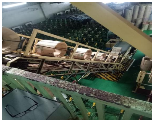
ภาพที่ 4.1 การลำเลียงกล่องวงล้อขึ้นมาจัดเก็บในคลังสินค้าโดยสายพานลำเลียง
