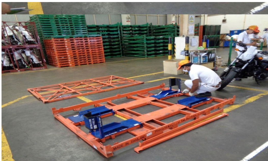
ภาพที่ 4.3 ประกอบชิ้นส่วนสีน้ำเงินเข้ากับเหล็ก
