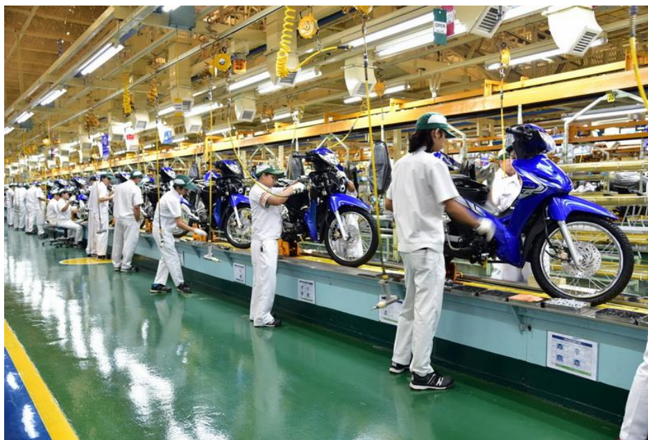
ภาพที่ 3.3 กระบวนการในการประกอบรถจักรยานยนต์
