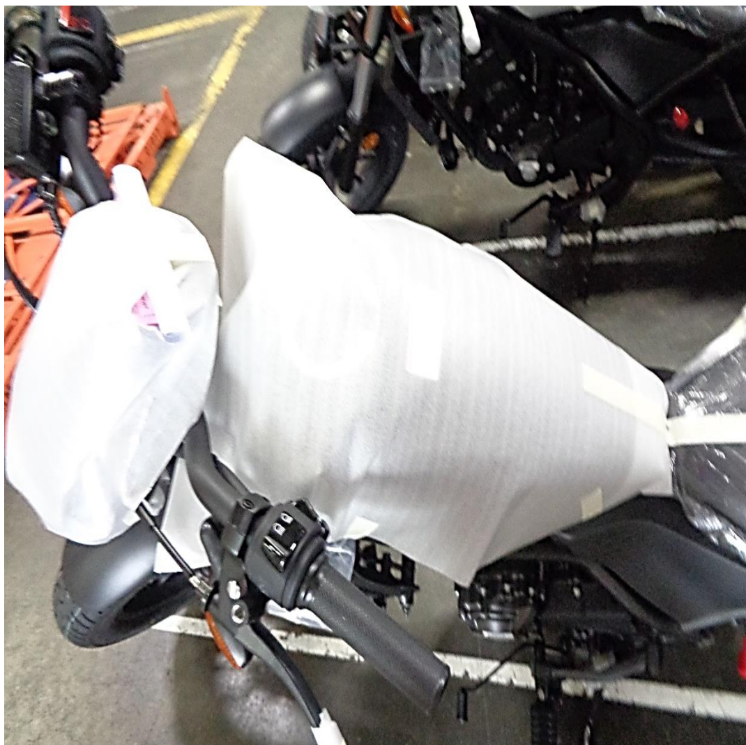
ภาพที่ 4.7 การห่อหุ้มโฟมกันรอยในบริเวณถังค้ำน้ำมันของรถจักรยานยนต์ที่ส่งขายต่างประเทศ
