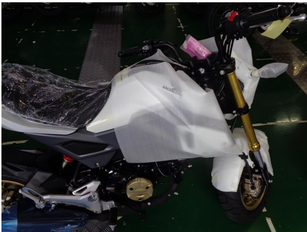
ภาพที่ 4.2 การห่อหุ้มโฟมกันรอยบริเวณถังค่าน้ำมัน
