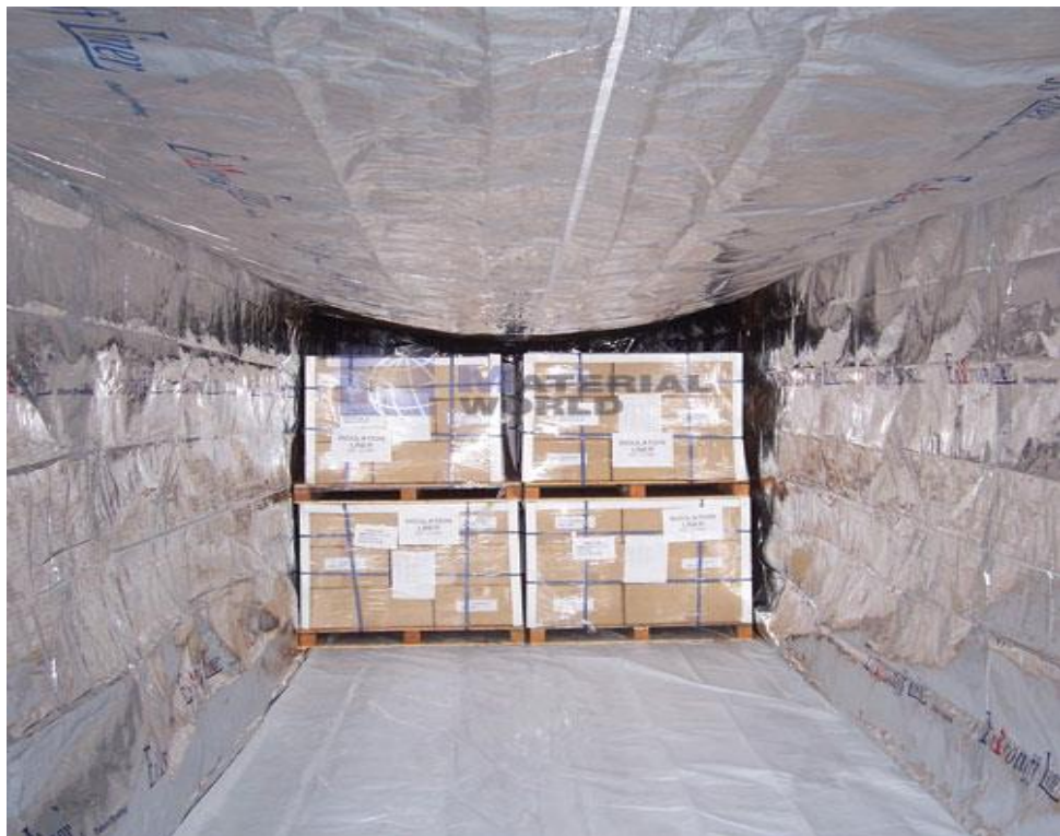
ภาพที่ 3.18 ตู้คอนเทนเนอร์แบบตู้ฉนวน
