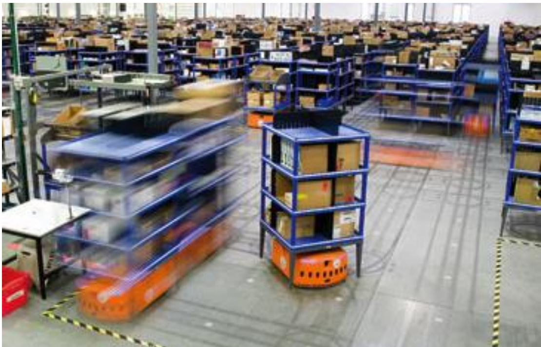
ภาพที่ 3.25 แสดงภาพระบบการจัดเก็บตามปริมาณความต้องการหยิบสินค้า
