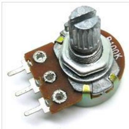
รูปที่ 2.35 ตัวต้านทานปรับค่าได้แบบวอลุ่ม (Potentiometer)
