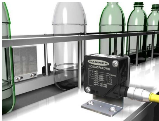
รูปที่ 2.26 ตัวอย่างการใช้งาน True Color Sensor
