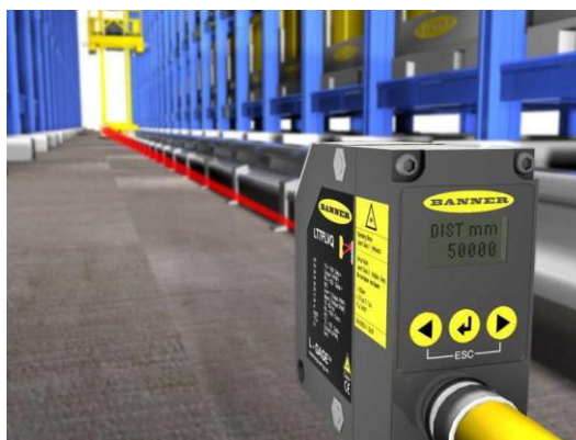
รูปที่ 2.30 ตัวอย่างการใช้งาน Laser Distance Sensor ในงานวัดและควบคุมระยะทาง ที่มา( https://mall.factomart.com/type-of-photoelectric-sensor/ )
