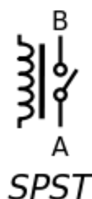
รูปที่ 2.50 SPST คือ Single Pole Single Throw , SPDT คือ Single Pole Double Throw
