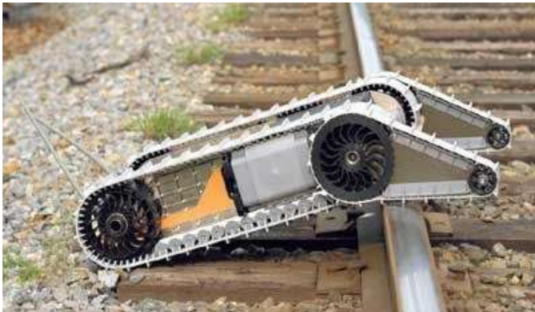
รูปที่ 2.30 การใช้กลไกการปีนป่าย ที่มา https://www.thairobotics.com/2013/10/25/byob-wheel-and-track-2/
