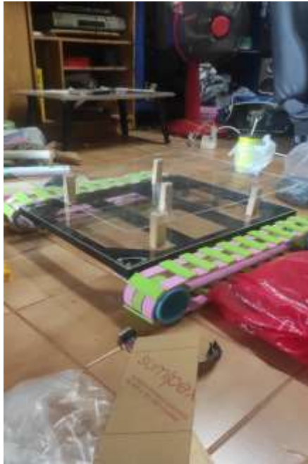
รูปที่ 4.1 ตัวรถโมเดลรถล้อตะขาบ (screen1) เป็นตัวโครงและล้อพร้อมแผ่นอะคลิลิก
