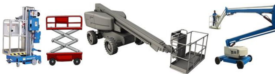
รูปที่ 2.1 แสดงรถกระเช้า Mobile Elevated Work Platform (MEWP)
