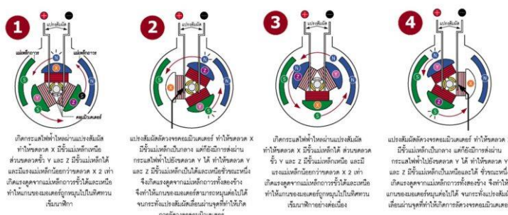
รูปที่ 2.80 แสดงส่วนประกอบและการทำงานของมอเตอร์ไฟตรงแบบขดลวด 3 ขั้ว
