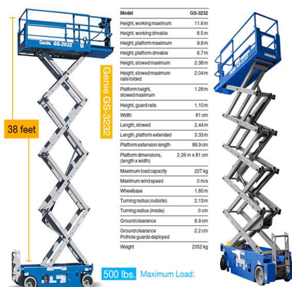
รูปที่ 2.7 ตัวอย่างข้อมูลทางวิศวกรรมของรถกระเช้าแบบกรรไกร
