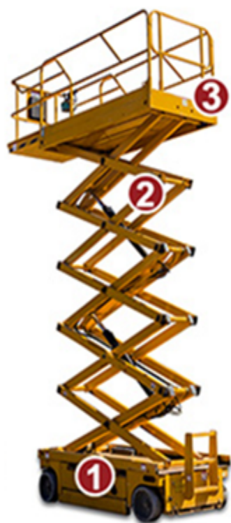
รูปที่ 2.3 คำอธิบายภาพรถกระเช้าแบบขากรรไกร
