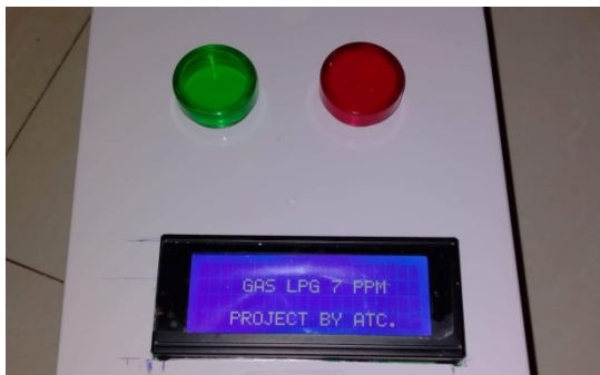
รูปที่ 3. หน้าที 3 แสดงหน้าการทำงานของเครื่องตรวจจับและแจ้งเตือนแก๊สรั่วไหล
