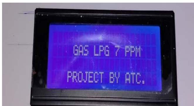
รูปที่ 4.2 หน้าที 2 เป็นหน้าจอแสดงผลค่าระดับแก๊สในอากาศที่กำลังลอยตัวอยู่ในอากาศ เมื่อค่าแก๊สในอากาศปกติจะแสดงสัญญาณไฟสีเขียว ถ้าค่าแก๊สในอากาศเกินที่กำหนดและสัญญาณไฟสีแดงเตือนพร้อมเสียง
