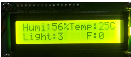
รูปที่ 4.2 อ่านค่าอุณหภูมิในอากาศจาก LCD
