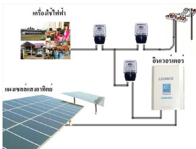
รูปที่ 2.2 ระบบผลิตไฟฟ้าด้วยเซลล์แสงอาทิตย์แบบต่อกับระบบจำหน่าย
