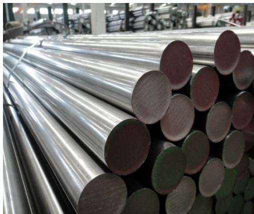
รูปที่ 2.20 ตัวอย่างเหล็กกล้าคาร์บอน ที่มา www.tpa.or.th
