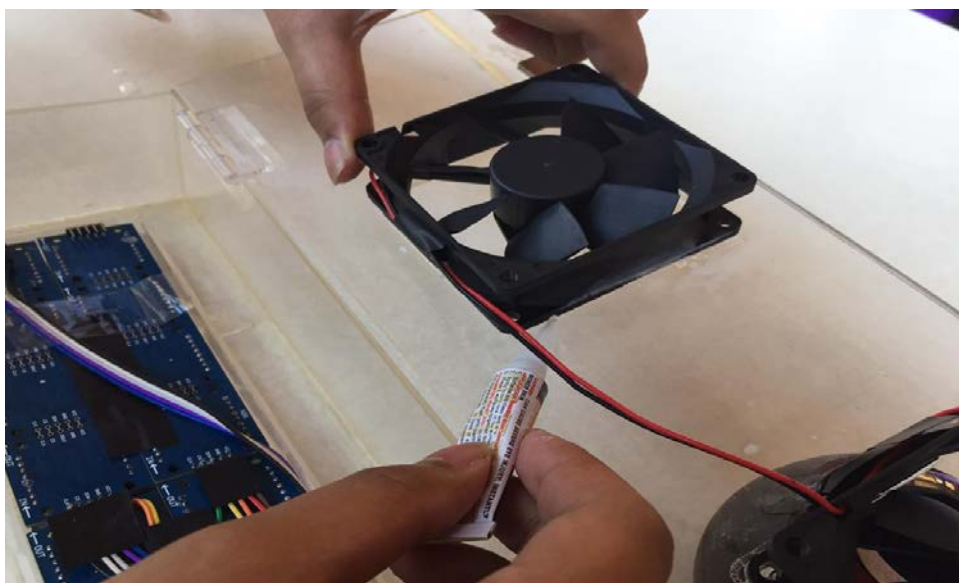
รูปที่ 4.5 ติดตั้งพัดลมลงบนเบส
