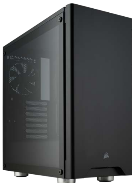
รูปที่ 2.5 ตัวอย่างเคสแบบ Mid Tower ที่มา www.bnn.in.th
