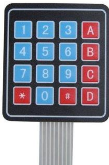
រូប​ព័ត៌មាន 4.3 4*4 keypad Arduino
