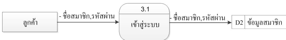
รูปที่ 3.8 Data Flow Diagram Level 1 Process 3 ระบบการเข้าสู่ระบบ
