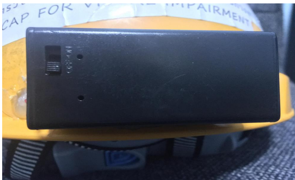
รูปที่ 4.1 รางถ่านที่ติด Switch สำหรับใช้ ปิด/เปิด
