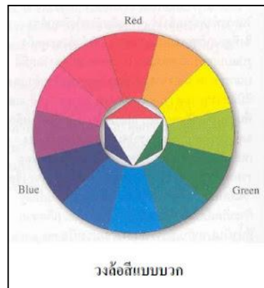
รูปที่ 2.9 รูปแสดงวงล้อสีแบบบวก
