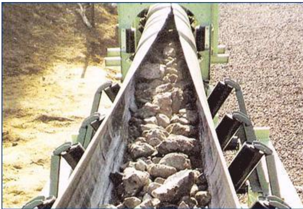
ภาพที่ 3.16 สายพานลำเลียงแบบโครงสร้างพิเศษ
