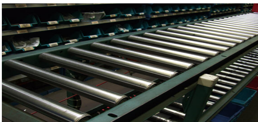
ภาพที่ 3.7 สายพานลำเลียงแบบยื่นเข้าไปในตู้
