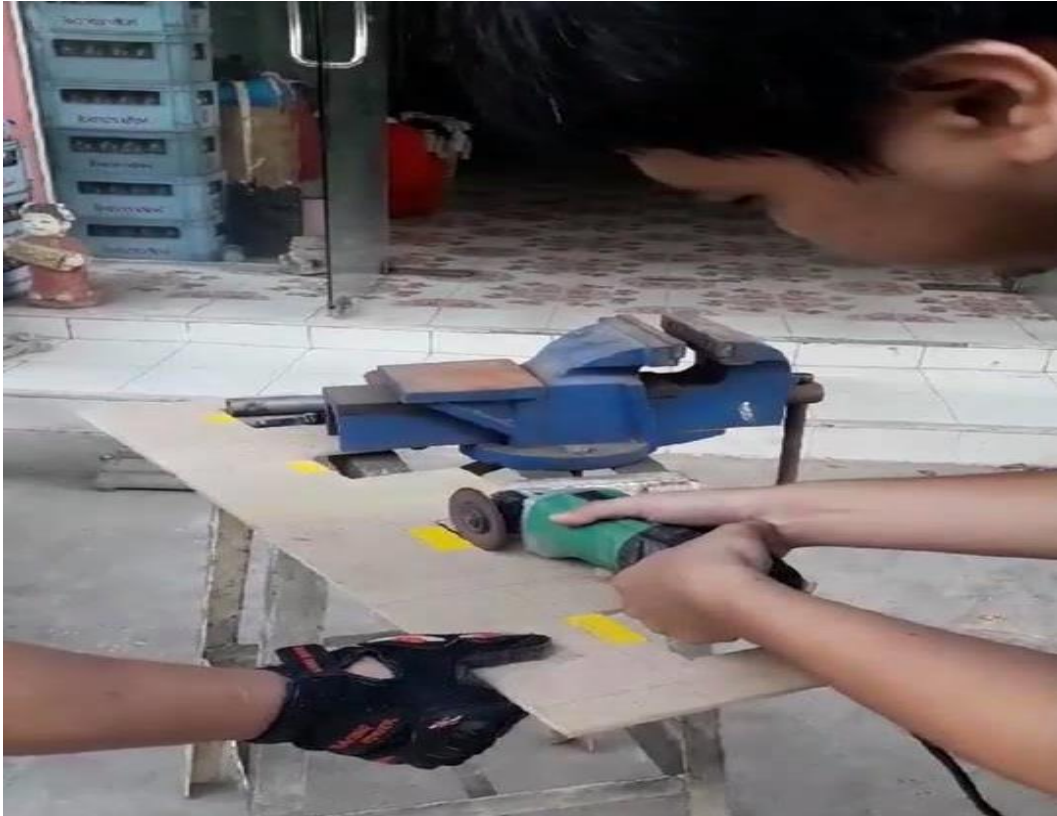
ตัดไม้อัดเป็นช่อง เข้าออกของคลั่งสินค้า
