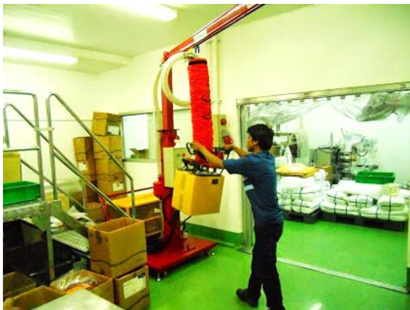
ภาพที่ 5.3 เครื่องช่วยยกผลิตภัณฑ์ที่มีน้ำหนักมาก
