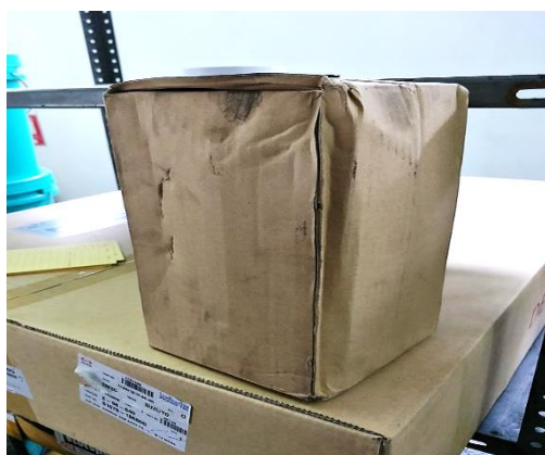
รูปภาพที่ 4.6 ความเสียหายของบรรจุภัณฑ์ที่เกิดจาก การกระแทกหรือตกหล่นขณะเคลื่อนย้าย
