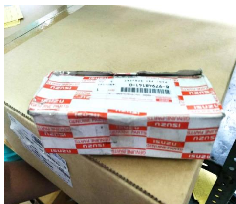
รูปภาพที่ 4.6 ความเสียหายของบรรจุภัณฑ์ที่เกิดจาก การกระแทกหรือตกหล่นขณะเคลื่อนย้าย
