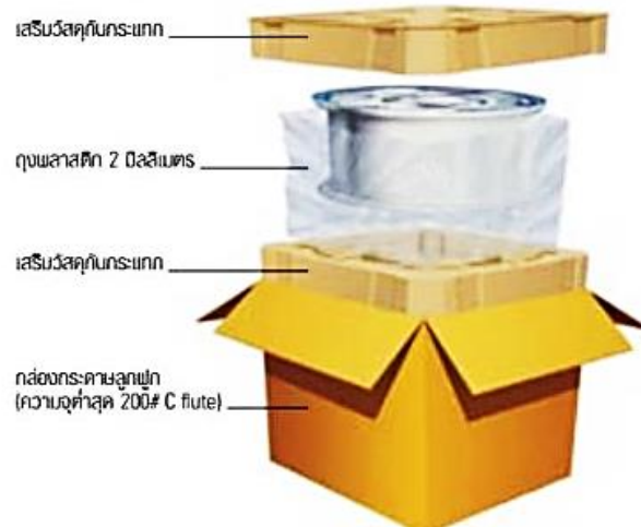
ภาพที่ 3.14 การออกแบบบรรจุภัณฑ์บรรจุอะไหล่รถยนต์ (เพื่อป้องกันขอบจากรอยขีดข่วน)
