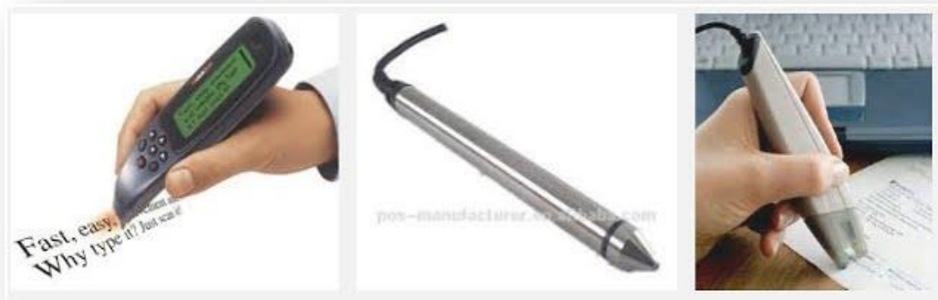
ภาพที่ 3.42 เครื่องอ่านแบบปากกา (Pen Scanners)
