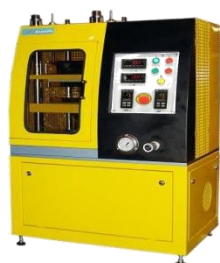
ภาพที่ 2.5 เครื่องอัดขึ้นรูปด้วยความร้อน
