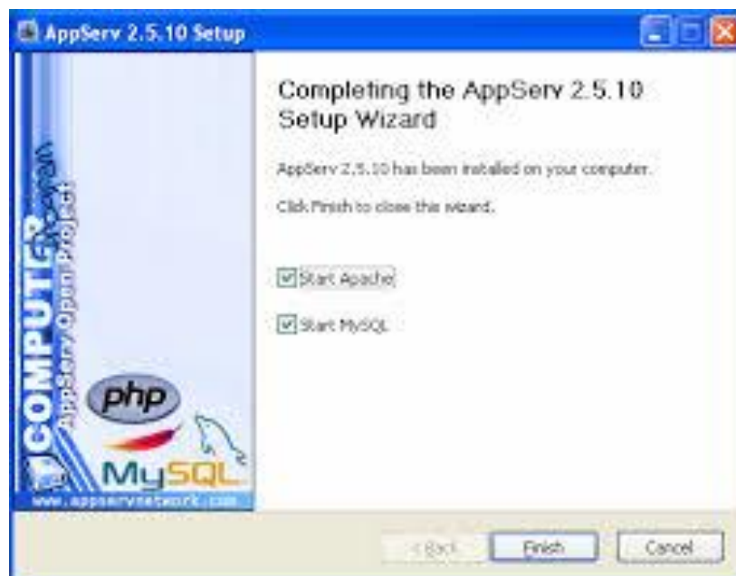
รูปที่ 4.8 เมื่อการติดตั้งเสร็จสิ้น ให้กดปุ่ม Finish ระบบจะทำการสตาร์ท (Start) โปรแกรม Apache
