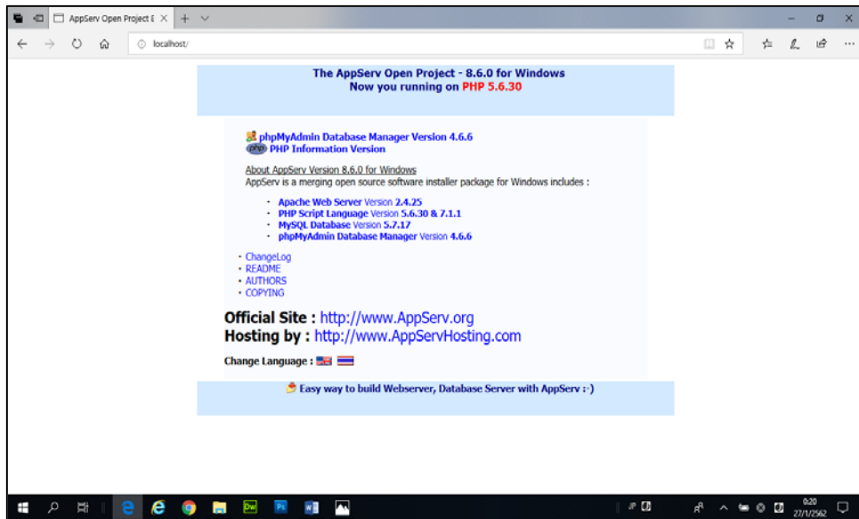
รูปที่ 4.14 เปิด โปรแกรมเว็บเบราว์เซอร์และพิมพ์ phpMyAdmin หรือคลิกที่ phpMyAdmin Database Manager Version 2013 เพื่อทำการเข้าสู่ระบบฐานข้อมูลภายในเครื่อง
