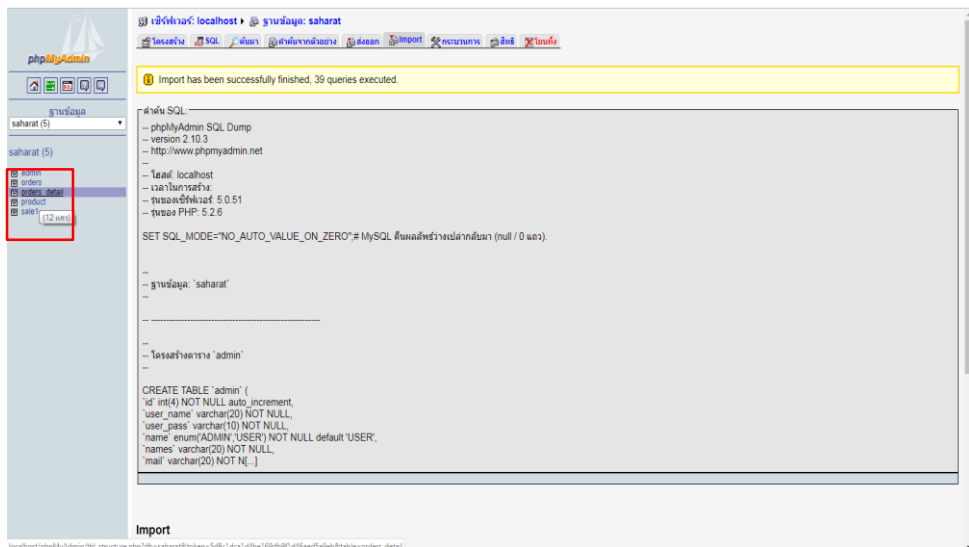
รูปที่ 4.18 เมื่อนำฐานข้อมูลของโปรแกรมเข้าสู่เซิร์ฟเวอร์เรียบร้อยแล้ว จะปรากฏตารางของฐานข้อมูล ประกอบไปด้วย 2 ตารางหลัก คือ ตาราง member และตาราง product ดังภาพ ซึ่งเป็นอันเสร็จสมบูรณ์ในการติดตั้งระบบฐานข้อมูล
