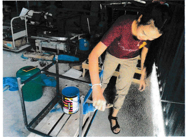
➤ เมื่อเชื่อมเหล็กเสร็จแล้วนำสีมาทาเพื่อเพิ่ม ความสดใส สวยงาม
