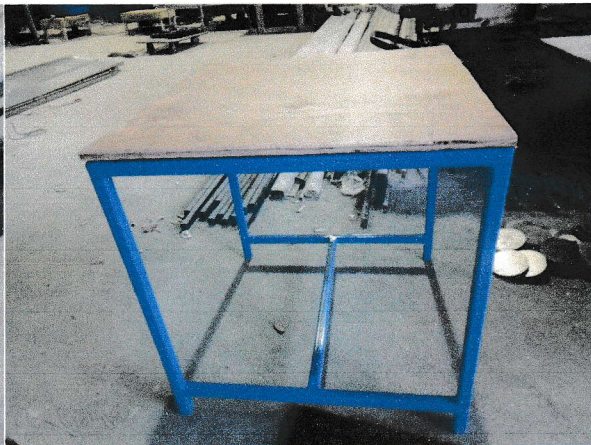
➤ นำแผ่นไม้อัดมาตอกเพื่อเป็นฐานโต๊ะรองรับการติดฝาจับ
