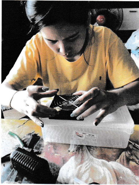
2. ใช้กาวยร้อนทาบริเวณที่ตัดเพื่อติดกับตัวพัดลม
