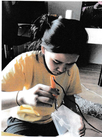
3. เจาะรูที่กล่องพลาสติกเพื่อใส่สายพัดลมและสายสวิตช์ เปิด - ปิด
