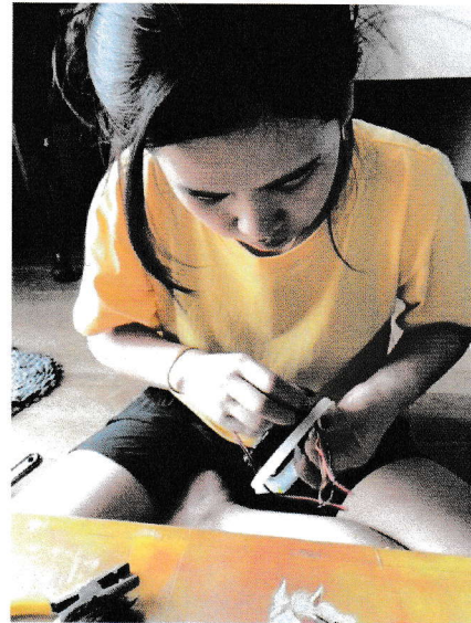
3. เจาะรูที่กล่องพลาสติกเพื่อใส่สายพัดลมและสายสวิตช์ เปิด - ปิด
